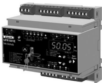
Gemäß der Anwendungsregel VDE-AR-N 4105:2018-11 ist in Deutschland für alle Erzeugungsanlagen von 30 kW bis 135 kW ein Netz- und Anlagenschutz erforderlich. Die Schutzeinrichtung überwacht die Spannung und Frequenz des Versorgungsnetzes, um die vorgegebenen Toleranzen einzuhalten und die Bildung von Inselnetzen zu verhindern. Der Netz- und Anlagenschutz nach VDE-AR-N 4105 trennt die Stromerzeugungseinrichtung fehlersicher nach 0,2 Sekunden. Fehlersicherheit bedeutet hierbei:
